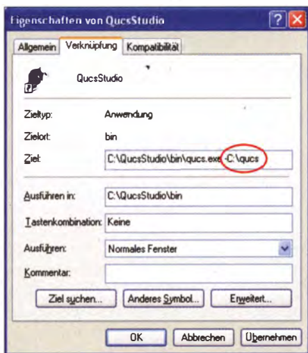
Bild 1: Eingabe des gewünschten Datenverzeichnisses (hier C:\qucs ) in eine auf dem Desktop angelegte Verknüpfung
