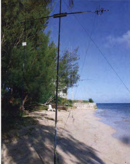
VDA-Antennen direkt am Strand – beste Abstrahlungsbedingungen gewährleistet
