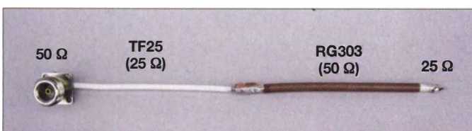
Bild 5: Impedanztransformation von 50 \Omega auf 25 \Omega bei 144,3 MHz, realisiert mit TF25 und RG303
