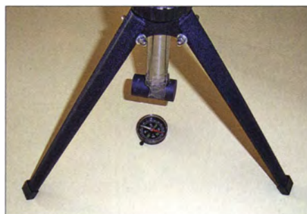
Bild 2: Beim ersten Versuch rotiert ein Magnet im Abstand von einigen Zentimetern über dem Kompass. Fotos: Sander
