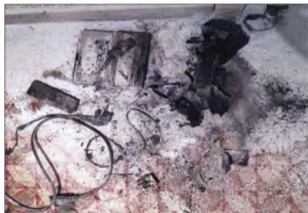
Ausgebrannter Lithium-Akkumulator im Hotel Foto: HB9BIN
