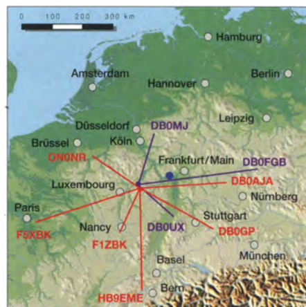
Bild 2: Von Mainz aus (blauer Punkt) über die eingezeichneten Regenscatter-Punkte auf 23 cm (rot) und 13 cm (violett) empfangene Baken
