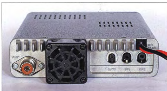
Auf der Rückseite der Haupteinheit befinden sich die Anschlussbuchsen für Antenne, Lautsprecher und Datenaustausch; der eingebaute Lautsprecher strahlt nach oben.
