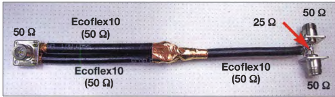
Bild 14: Aufbau der Impedanztransformation von 50 Ω auf 25 Ω bei 144,3 MHz, realisiert nur mit Ecoflex10
