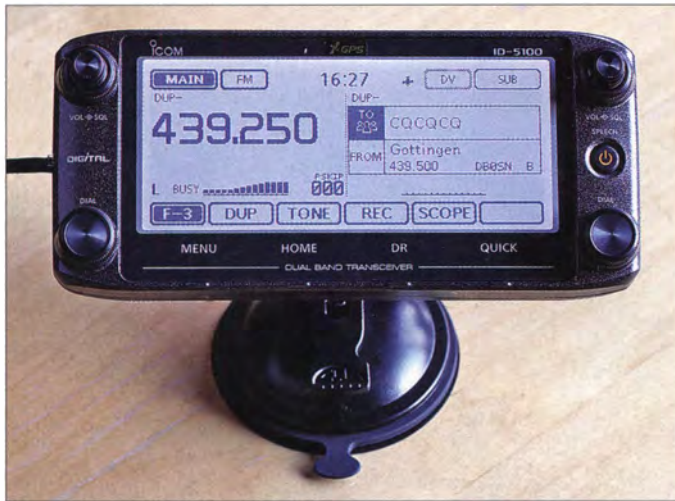
Die separate Bedieneinheit des ID-5100E ermöglicht eine komfortable Steuerung der zahlreichen Funktionen.
