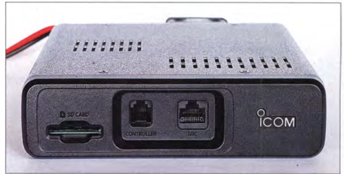
Auf der Frontseite des Transceivers liegt u. a. ein Slot für SD-Speicherkarten.
