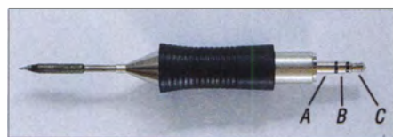
Bild 2: RT -Lötspitze mit Anschlussbelegung des 3,5-mm-Klinkensteckers: A liegt auf Masse, an B ist der Sensor und an C die Heizung angeschlossen.
